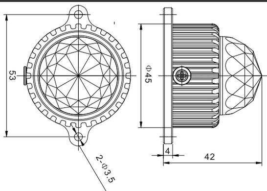
2 trous de montage  $\text{Ø}=3,5\text{mm}$ ,
